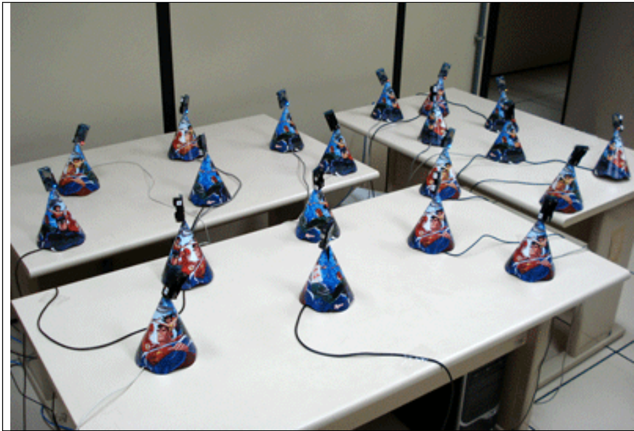
Figura 4.4: Cones utilizados para suspender os Tmotes e evitar interferências do solo na transmissão na topologia 2.
