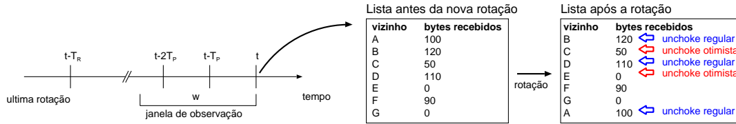
Figura 2.3: Execução do algoritmo de seleção de pares com rotação, para x_r = 3 e x_o = 2 .
