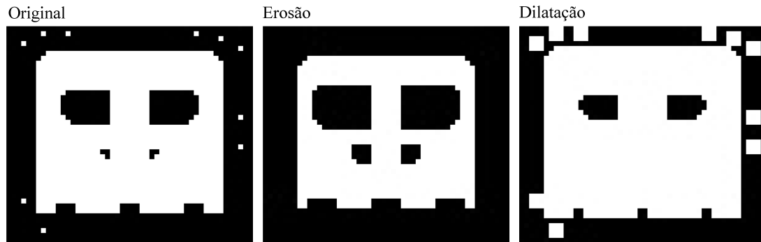
Figura 3.2: Erosão e dilatação em uma imagem
