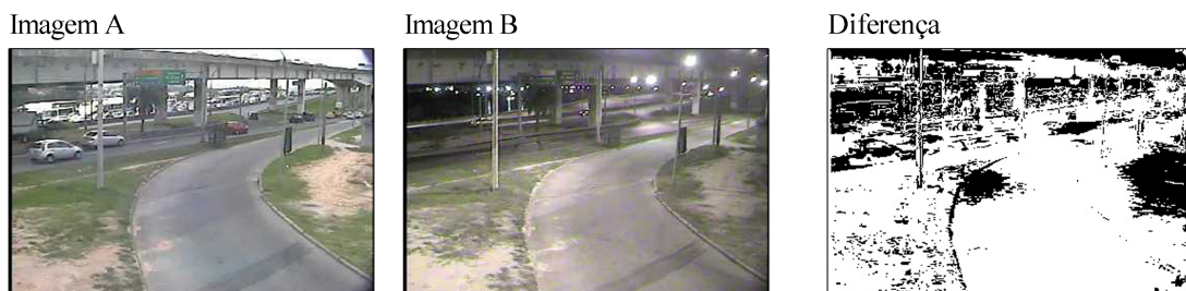
Figura 6.10: Diferença de imagens com iluminação diferente
