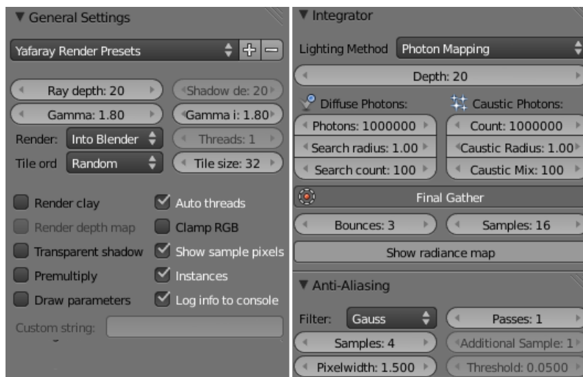
Figura 7.7: Configuração geral do Yafaray pela interface do Blender.
