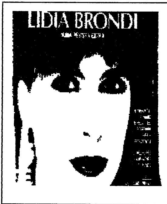
Figura IV.2b - Binarização de LIDIA.pic com janela 1x1, limite mínimo = 32, limite máximo = 32, delta nível = 0.
