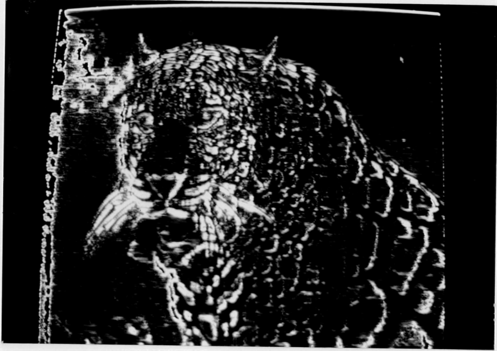
Figura V.6: A foto mostra o resultado de sensibilidade da máscara orientada com orientação de 135^{\circ} .
