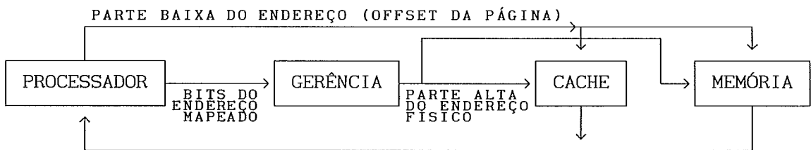
figura 2.5: diagrama em blocos de um sistema de cache de endereço físico e busca na cache em paralelo
