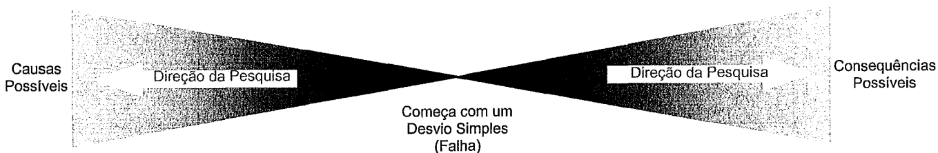
Figura 5.16 – A Técnica Exploratória trabalha em ambas direções, para-frente buscando as possíveis consequências e para-trás buscando as possíveis causas.
