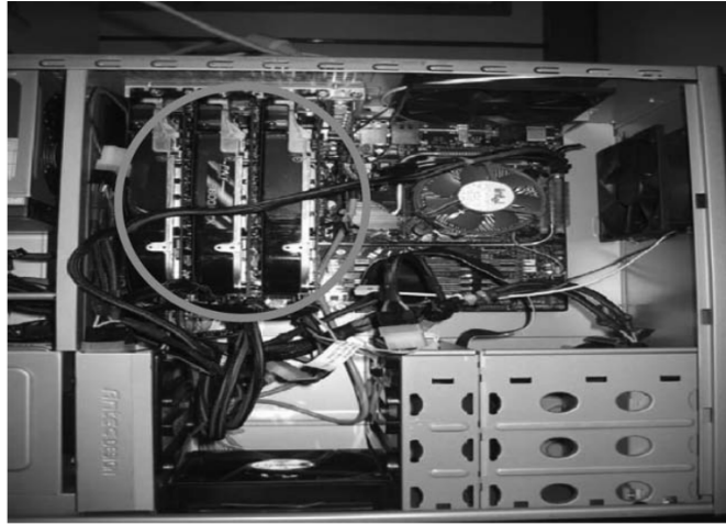
Figura 2.6: Um PC com três placas Geforce 8800 GTX e uma fonte de 700W. Figura retirada do livro Programming Massively Parallel Processors A Hands-on Approach .
