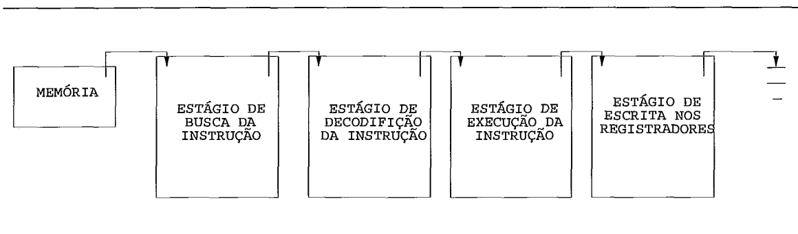
Figura 4.6. - Estrutura do pipeline de instrução.
