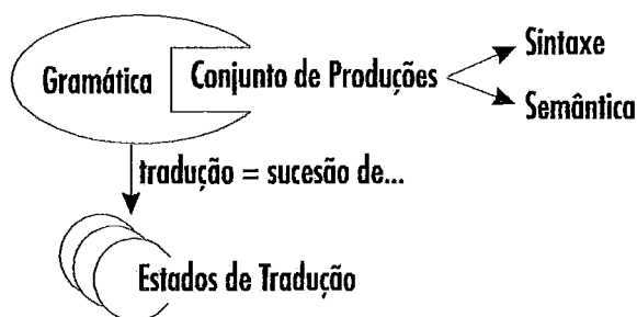
Figura 5.5 - No processo de tradução, objetos da classe EstadoDeTradução se sucedem na caracterização do estado do autômato de pilha. Cada estado é um objeto atuante no processo de tradução, realizando a construção de novos estados e deixando a pilha operacional disponível para as produções à medida que elas são aplicadas.
