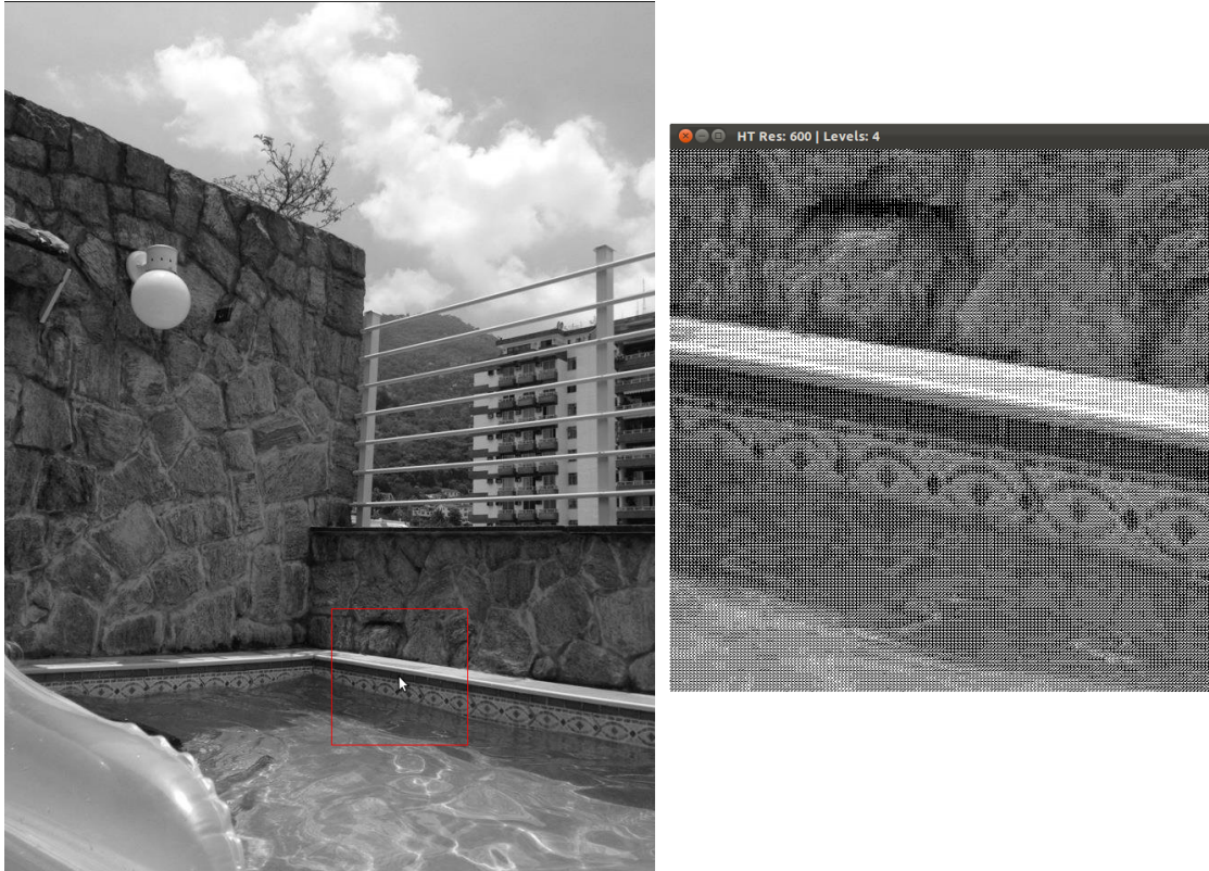
Figura 4.11: À esquerda a imagem original em tons de cinza e à direita a região da imagem onde o halftoning foi aplicado utilizando uma resolução de 600 pixels , máscaras aleatórias com dimensão de 4x4 e uso da correção gamma , com \gamma = 1.5 .
