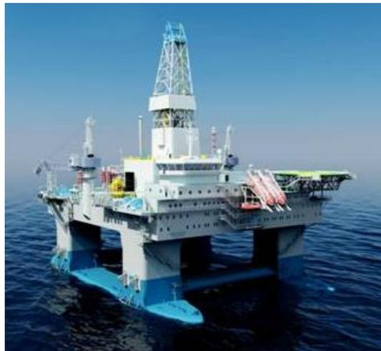
**Figura 5: Plataforma Semi-submersível**
