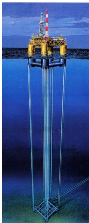
**Figura 3: Plataforma Tension Leg**
