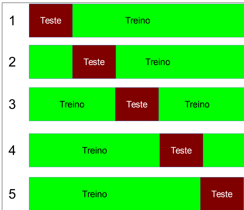
Figura 6.1: Desenho esquemático de teste de validação cruzada "5-fold"
