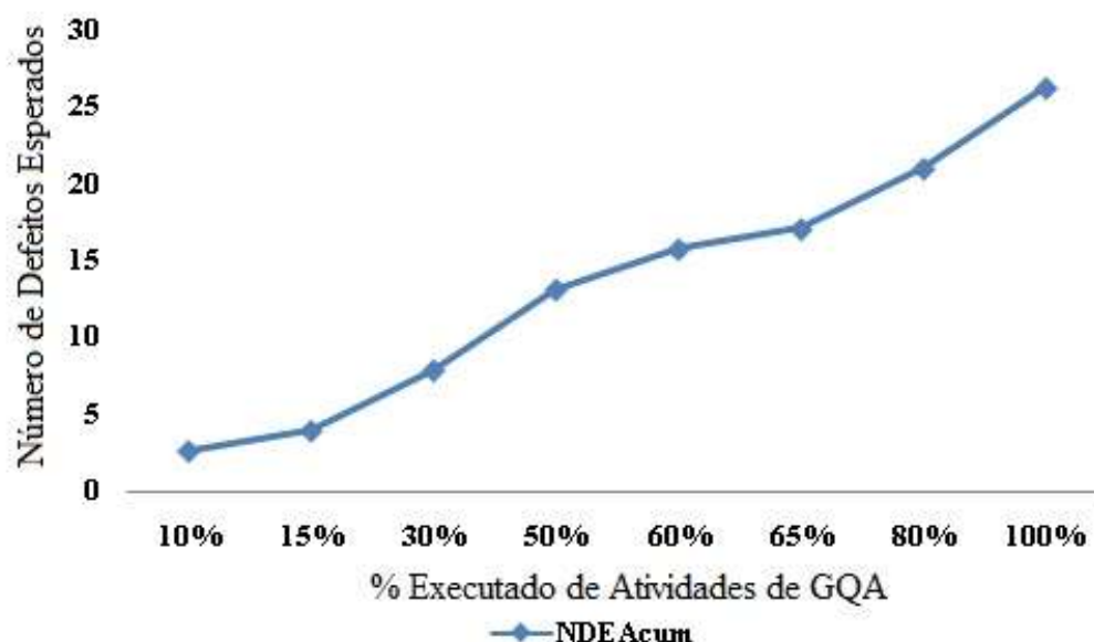
Figura 3.9 – Número de Defeitos Esperados Acumulados ( NDE_{Acum} ) para o Projeto, em Função do % Executado de Atividades de GQA
