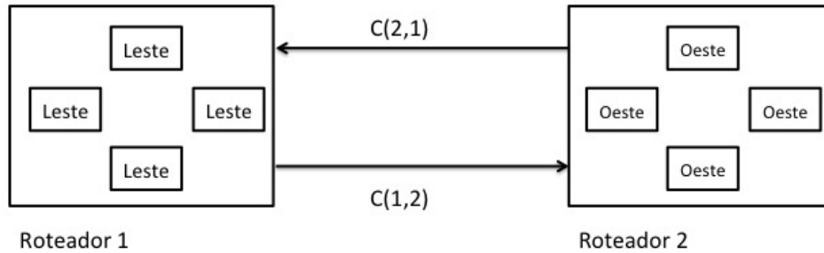
Figura 4.6: Dois roteadores bloqueados devido a dependência cíclica causando deadlocks .
