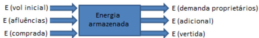
Figura 24: Balanço de energia com a possibilidade de compra de energia
