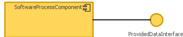
Figura 49 - Representações Gerais de uma Interface de Dado de Componente de Processo de Software
