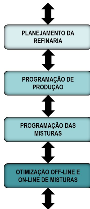
Figura 1.1. Hierarquia das decisões no dia a dia da operação de uma refinaria.
