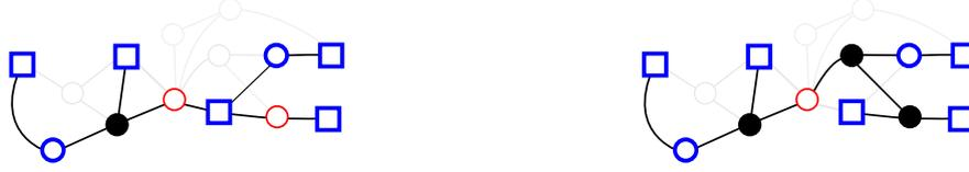
(a) Árvore de conexão para  $W'$  com dois elos e um roteador.
