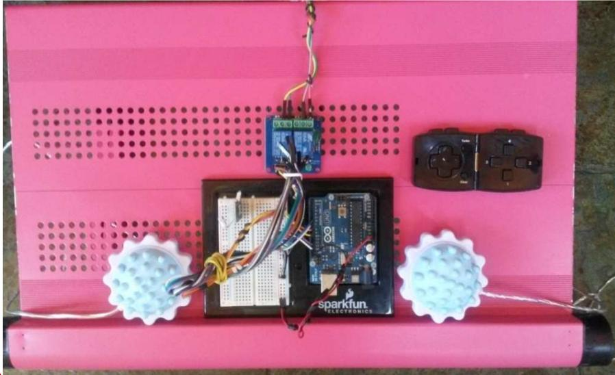
Figura 35–Placa arduino, dispositivo para estimulação tátil e dispositivo de interação em ambiente RV e RA
