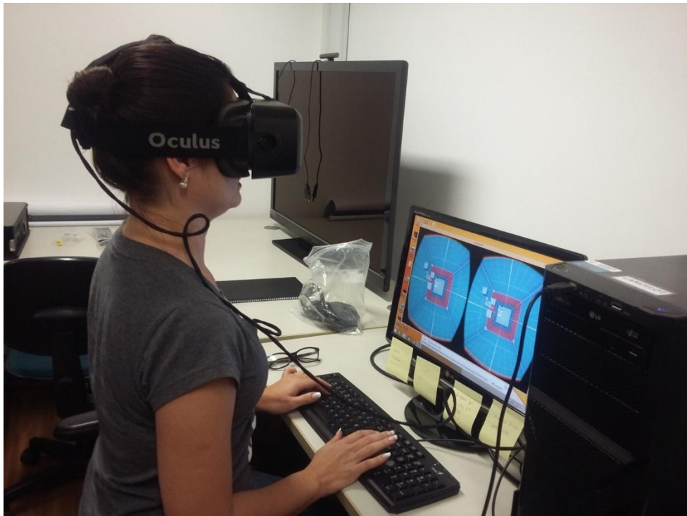
Figura 2.1 - Oculus RIFT, um exemplo de HMD
