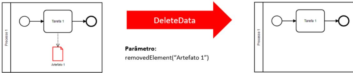
Figura A.1: Representação da operação Delete Data definida pela extensão BPMNt++. Figura criada pelo autor.
