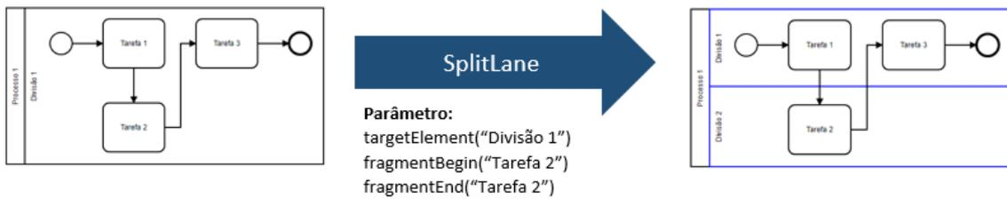
Figura A.13: Representação da operação Split Lane definida pela extensão BPMNt++. Figura criada pelo autor.
