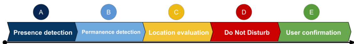
Figura 11. Fluxo de trabalho do mecanismo de detecção automática de espera (adaptado de OLIVEIRA et al., 2017)
