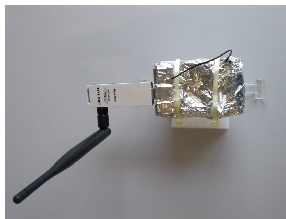
Figura 4.7: Raspberry com blindagem e antena externa.
