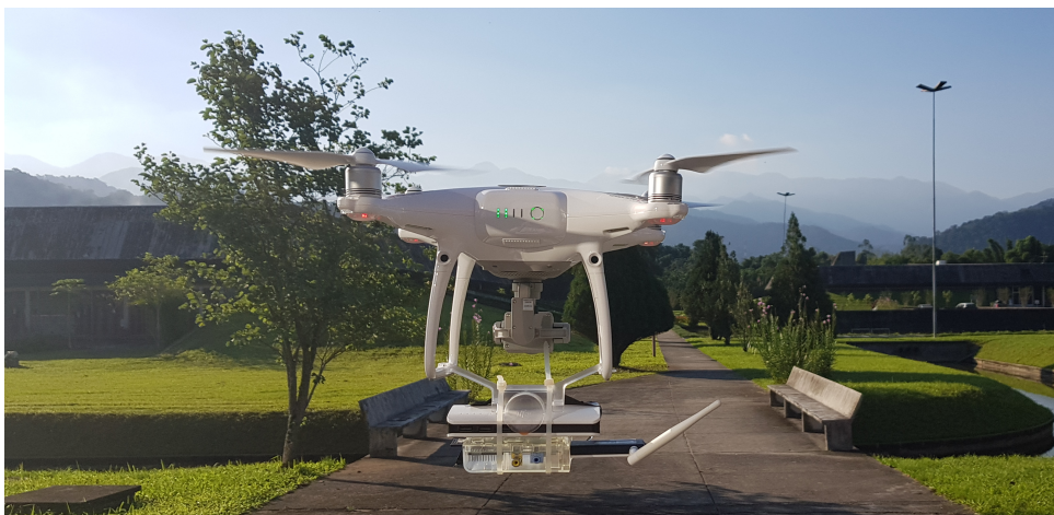
Figura 3.9: Drone Phantom e Dispositivo Raspberry acoplado com bateria.
