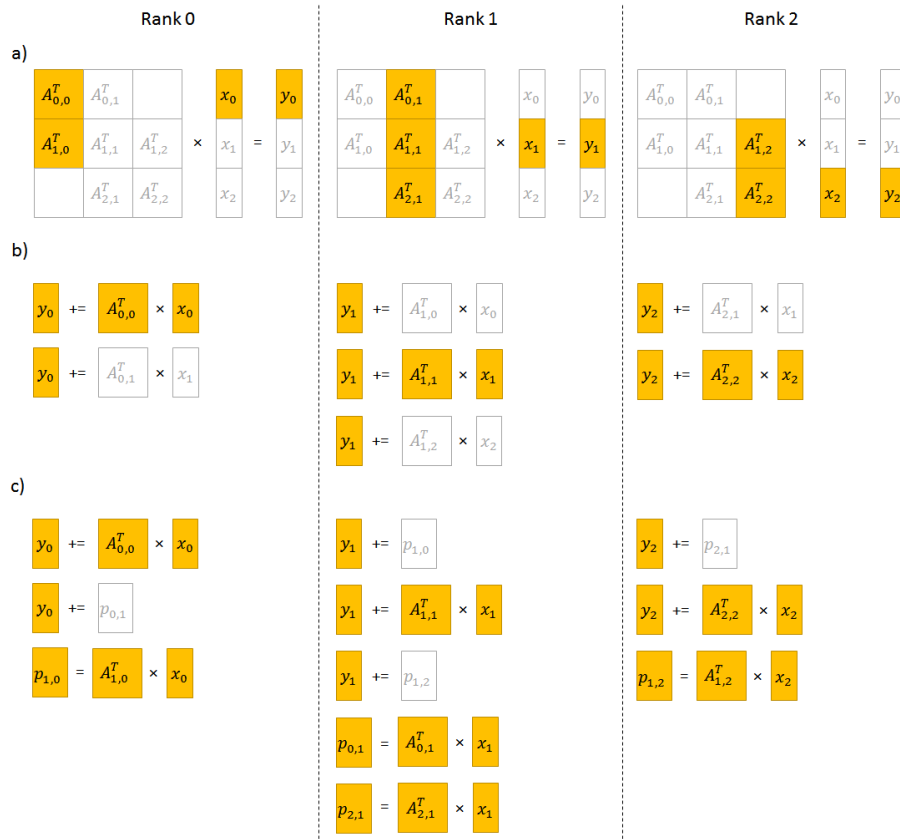
Figura 3.9: Exemplo de multiplicação de vetor por matriz transposta
