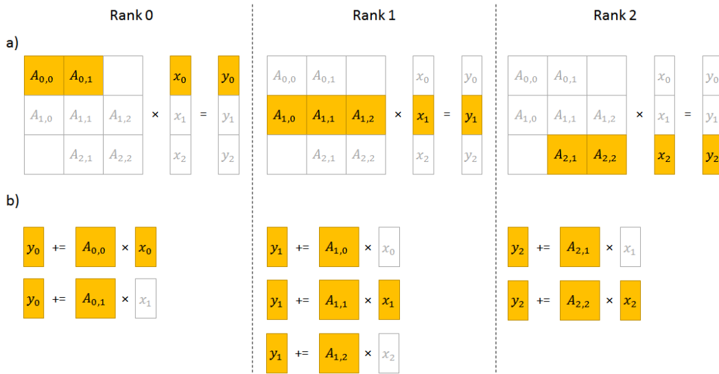
Figura 3.1: Exemplo simplificado de multiplicação matriz vetor com 3 ranks MPI
