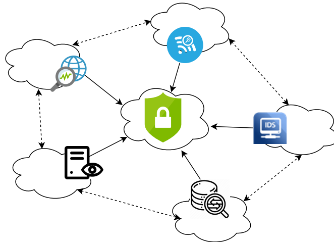
Figura 2.4: Arquitetura básica de um DIDS, onde os 5 IDSs distintos enviam mensagens entre si próprios e para um centro de processamento centralizado.
