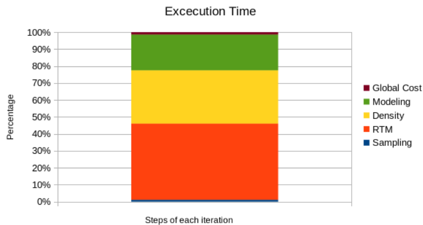
Figura 4.8: Percentual do tempo de execução total da simulação consumido por cada etapa das iterações.
